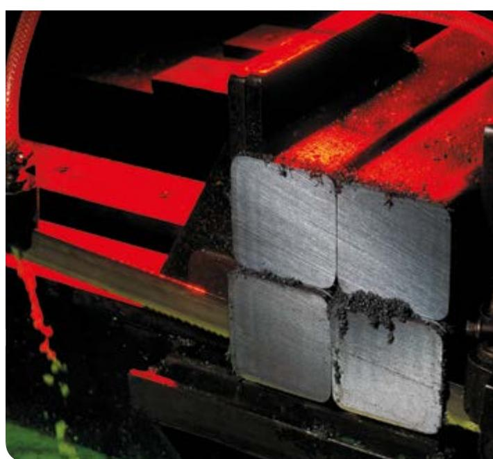
**Piła taśmowa bimetalowa;** Bi-metal band saw blade; Ленточная биметаллическая пила
