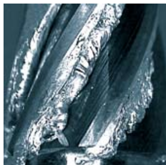
Pilnik niepowlekany - widoczny narost
